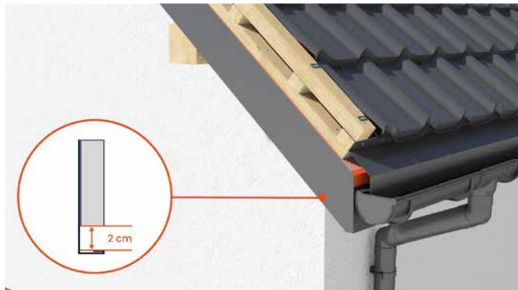
18. attēls Vējdēļa montāža ievērojot 2 cm pārslaidumu.
