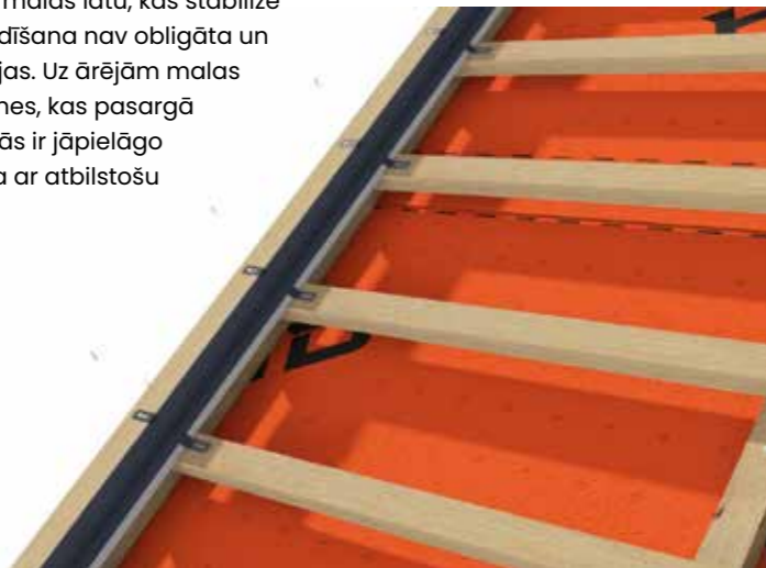
Rys 11 Sposób montażu rynienki odpływowej.
