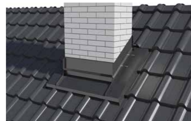
22. attēls Augšējā apdares elementa piestiprināšana pie skursteņa ar dībeļiem.
